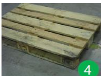
Prasta bendra padėklo būklė: - užterštumas (pvz. tepalais, riebalais, cementu) - neleistinų elementų – lentelių, vinių – naudojimas - netinkamas elementų pozicionavimas, pvz. kaladėlė persikėlė lentų atžvilgiu.
